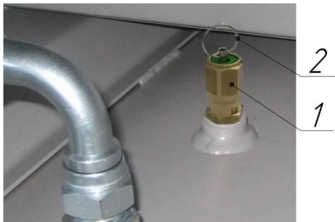
Рисунок 9 – Клапан предохранительный пружинного типа
